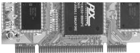
Рисунок 2 - Различия в исполнении плат «КОДОС Р8_2», «КОДОС Р8_2х»
